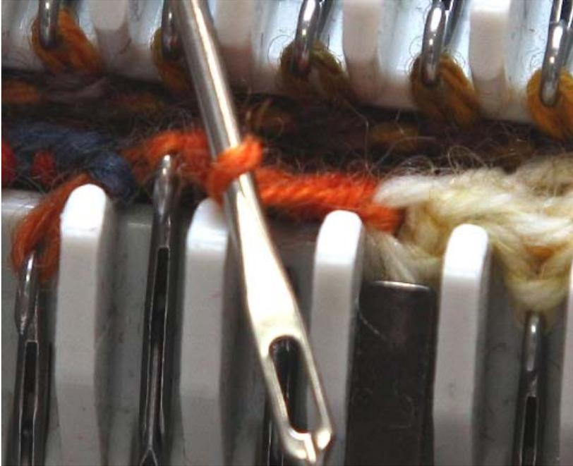
Bild 16: Gedrehter Querfaden
