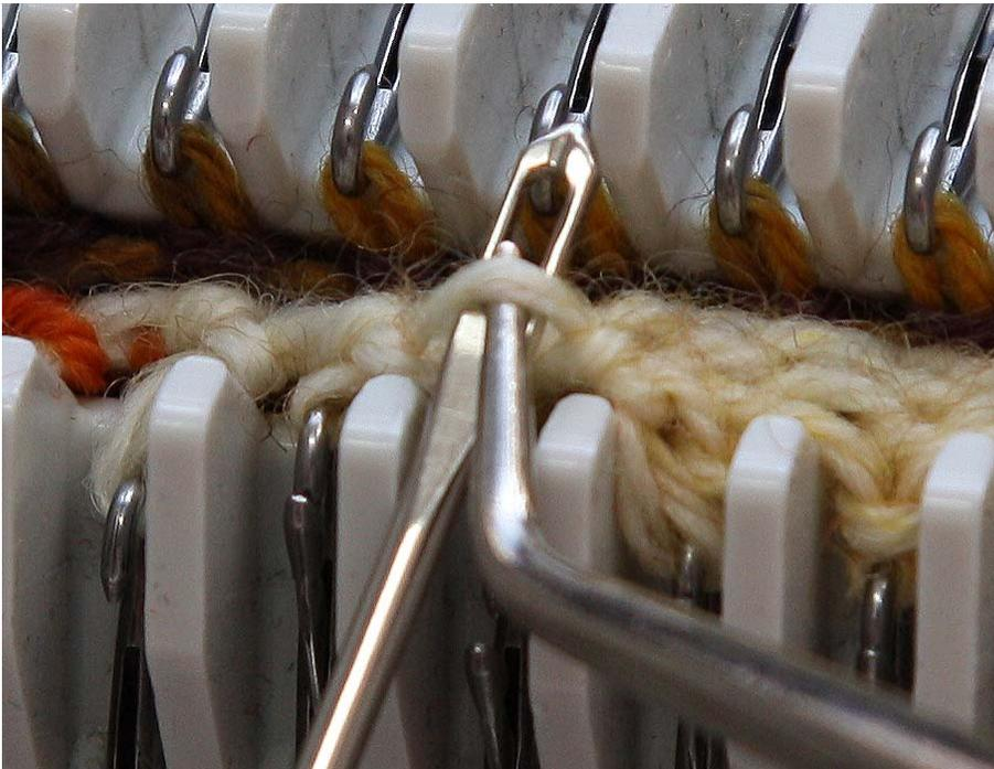
Bild 15: Aufnehmen des Quersfadens und Einschleiben der Hilfsnadel zum Drehen.
