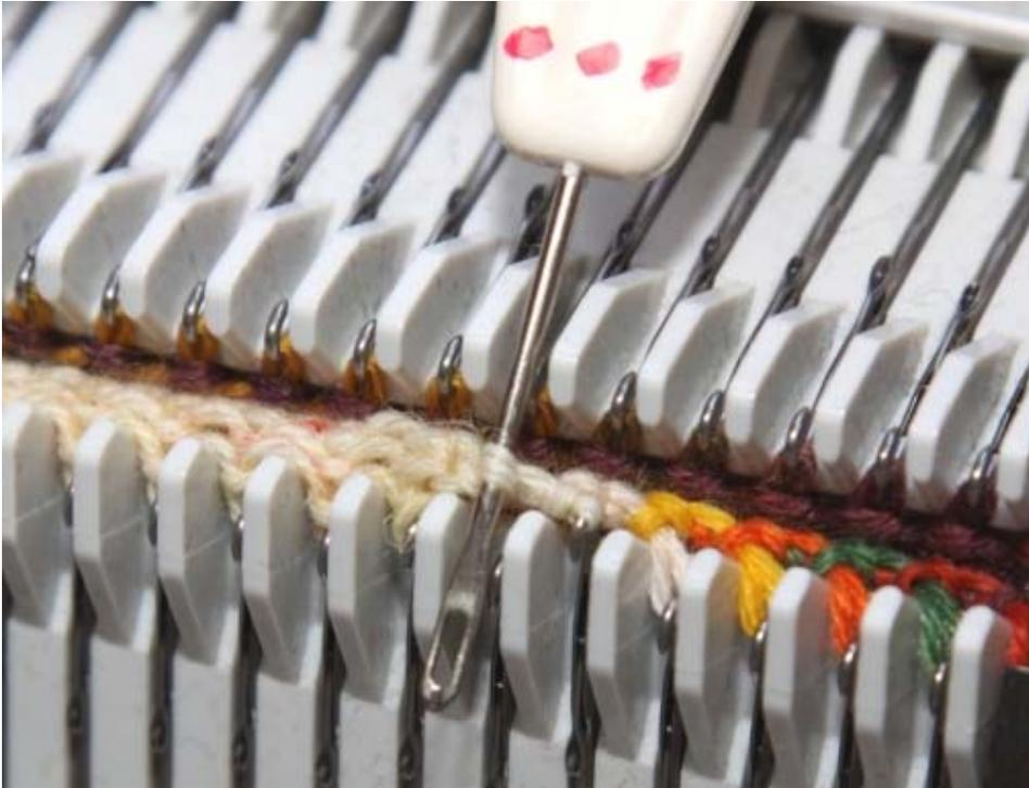
Bild 9: Der gedrehte Quersfaden bildet nun eine Schlaufe
