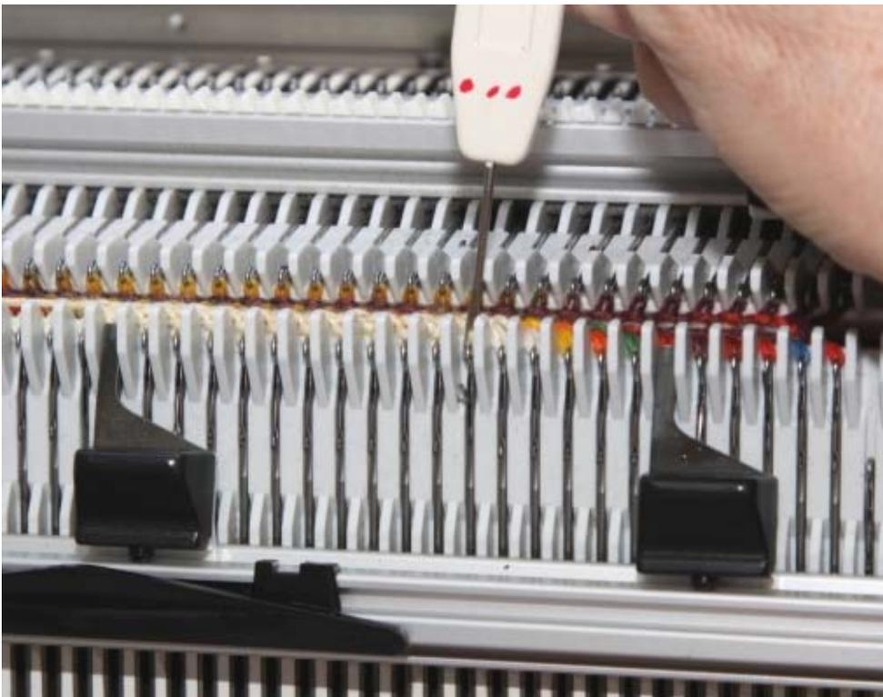
Bild 4: Masche wird von 'reaktiver Nadel' auf die letzte 'aktive' Nadel gelegt.
