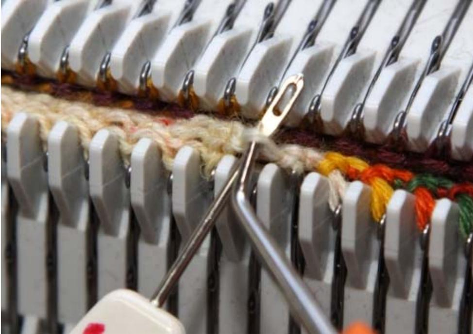
Bild 7: Einführen einer Hilfsnadel zum Aufnehmen des Quersfadens.
