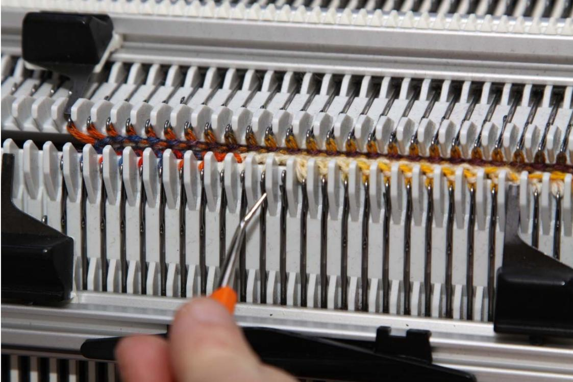
Bild 14: Links nach rechts: die 2. Masche in Ruhestellung, die leere Nadel, und rechts davon die Nadel mit den beiden Maschen (letzte aktive und erste ruhiggestellte Masche)
