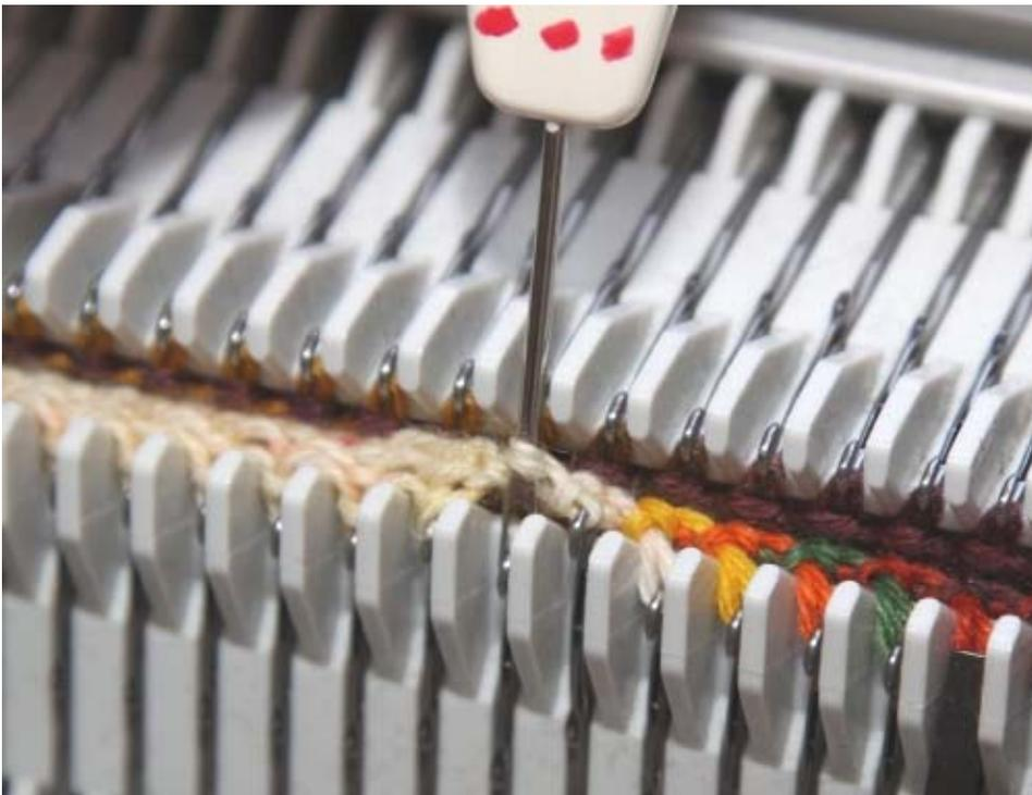
Bild 10: Die Schlaufe wird nun auf die leere Nadel gelegt und bildet eine neue Masche
