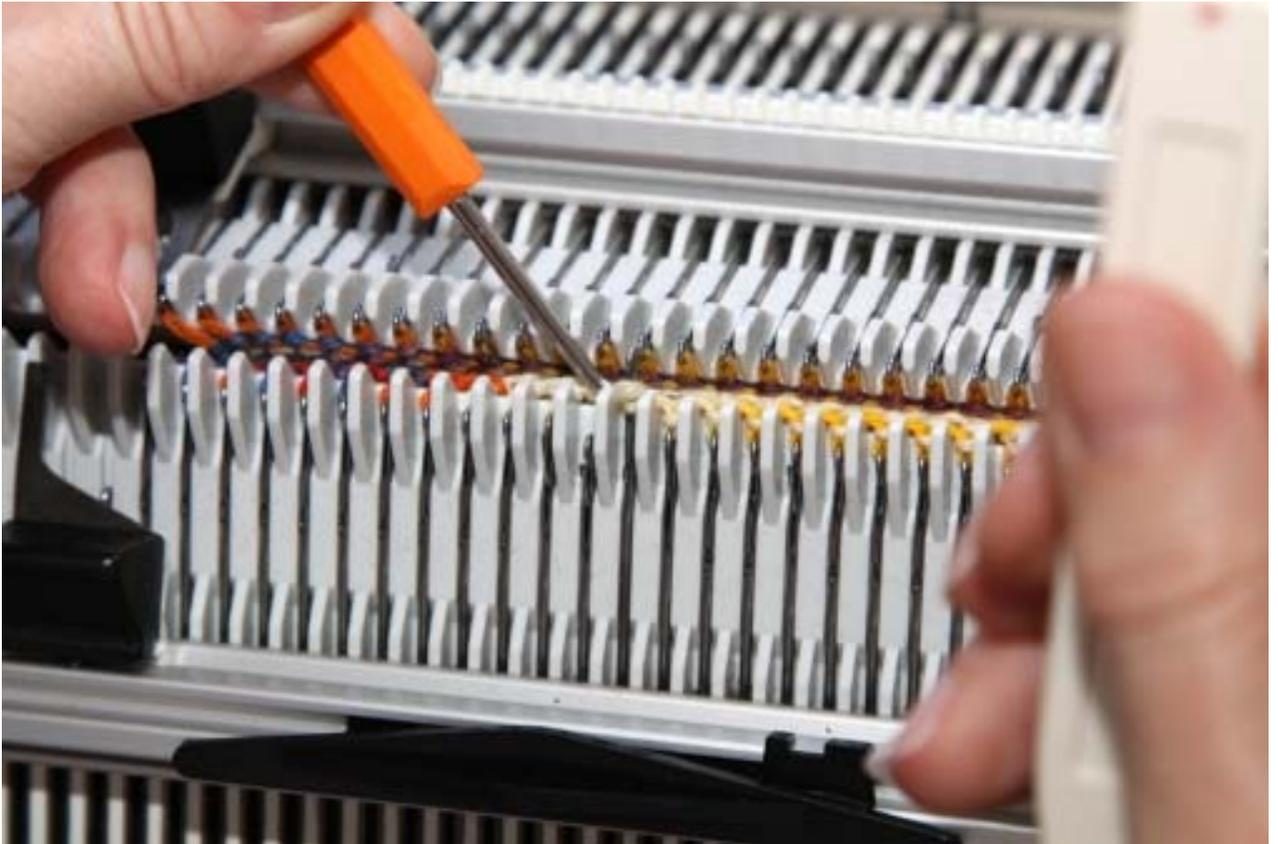
Bild 13: 2 Maschen zusammenlegen an der linken Seite der Mittelnadeln
