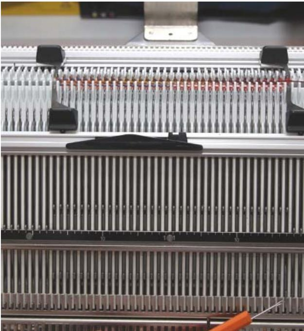
Bild 1 Erster Stößer rechts in Ruheposition
