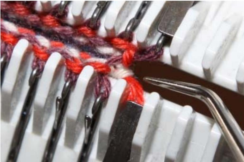
Bild 18: Die übersprungene Nadel von der ersten Runde, mit dem Quersfaden (Burgund) von der letzten Nadel des hinteren Bettes auf die zweite Nadel des Vorderbettes
