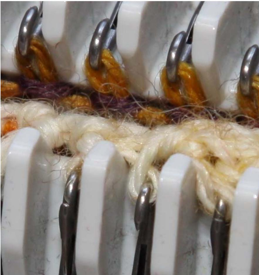
Bild 17: (Links nach rechts) Masche in Ruhestellung, gedrehte Schlaufe, 2 Maschen auf Nadel
