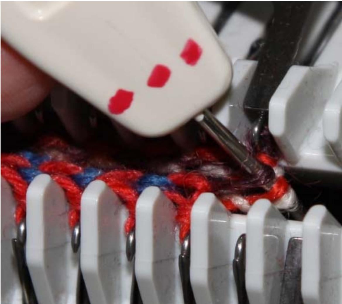
Bild 19: Dehnen der Fäden nach der Aussenseite, um einen brauchbaren Quersfaden zu finden.
