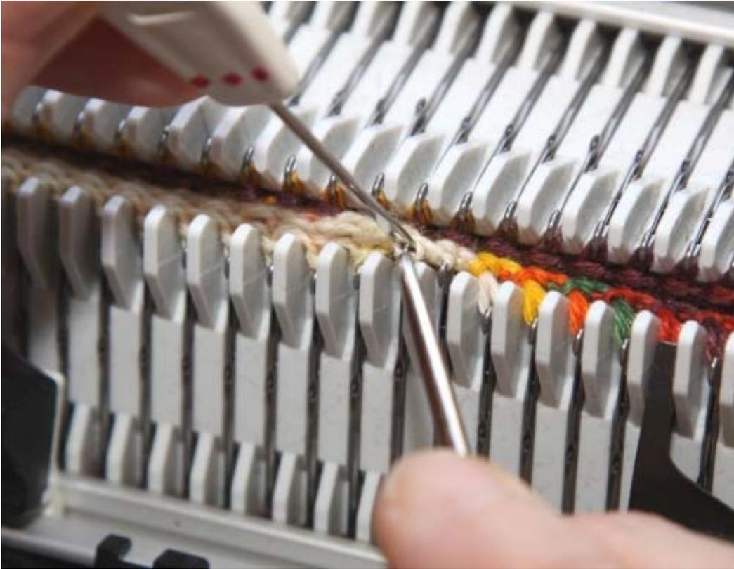
Bild 11: Mit der orangen Hilfsnadel, Geduld und einer zweiten Hilfsnadel wird die Schlaufe über den Nadelkopf gezogen.
