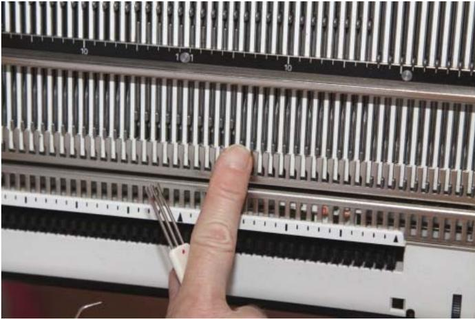
Bild 3: Der erste Stößer auf der rechten Seite wird wieder in Arbeitsposition geschoben
